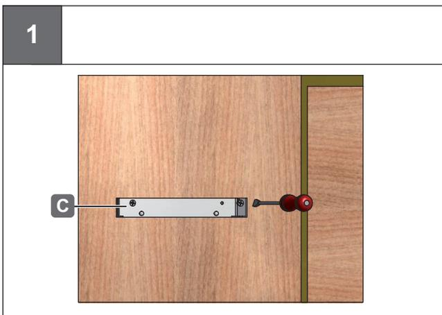
Halteleiste (C) mittels 2 Holzschrauben an der Tür befestigen.
