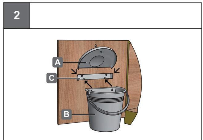
Eimer (B) und Deckel (A) in die Halteleiste einsetzen.
