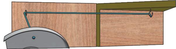
Bei geöffneter Tür und Deckel einen Knoten am Schnurende am Deckel und einen Knoten bei straff gespannter Schnur hinter der 2. Öse knüpfen.
