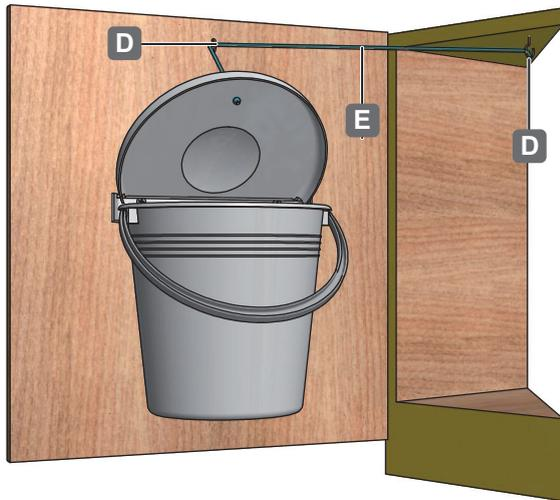
1. Öse (D) senkrecht über der Deckelbohrung in Höhe des ausgeklappten Deckels einschrauben.
