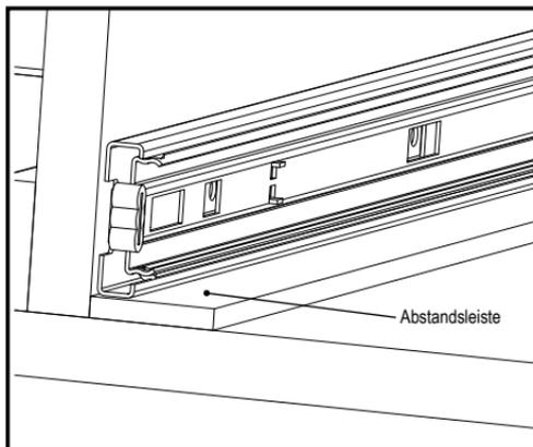
**Untermontage von Schubladenschienen**
